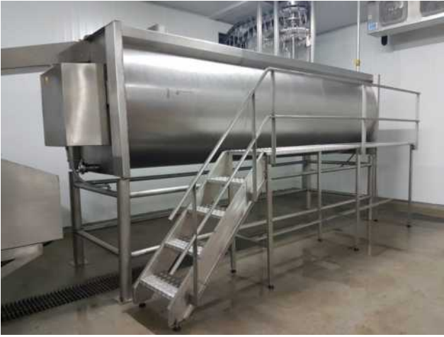
Prechiller Rotating prechiller
